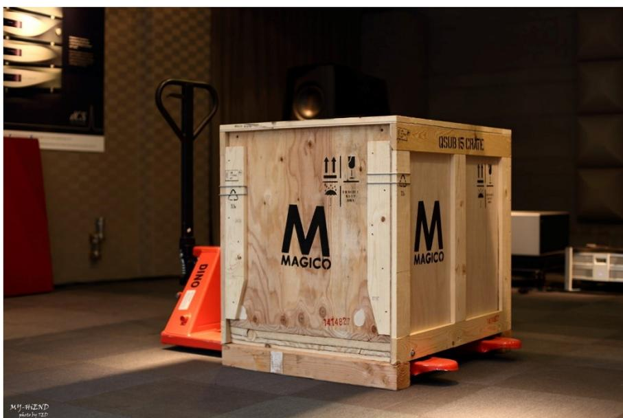
將正面的木板拆卸後，原廠發揮巧思將其利用成傾斜式的坡道，直接套入底板上的卡榫，在將喇叭推下時也不會滑脫。代理商說 Magico 的運送箱一直在改良，現在已經是非常輕鬆而且方便的設計了。在喇叭出廠時，都在角錐安裝的螺絲母孔中先安裝滑輪，讓安裝人員可以擺放至需要的位置後拆卸換成專用角錐。
