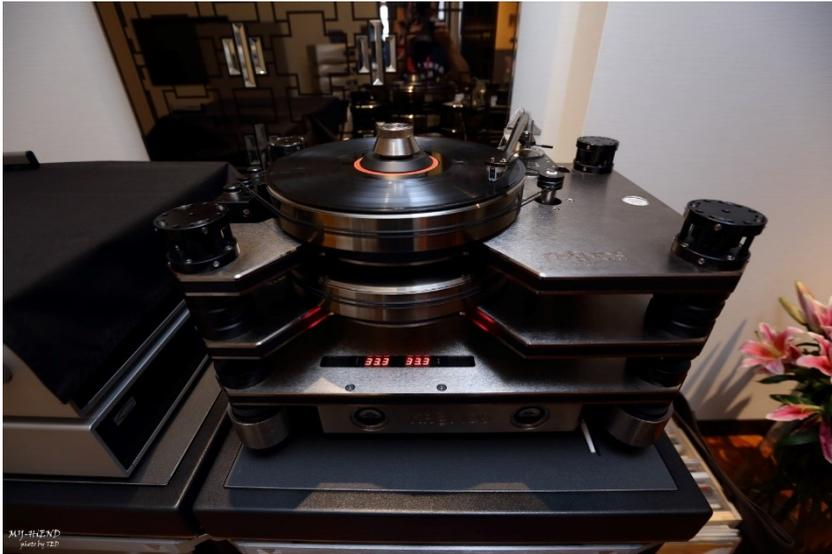
Kronos 的盤身也是採用導震設計，但 Kronos 用特別的方式解決扭力震動的問題，使用兩個馬達分別驅動兩個不同方向的轉盤同時運作(Dual platter counter-rotating revolution)，一個順時針轉動，另一個逆時針轉動，讓兩者產生的扭力互相抵消，就不會產生扭力震動。這樣的解決方式效果非常顯著，他當場示範了只使用一個轉盤播放音樂，讓另一個轉盤停止，然後再同時讓兩個轉盤轉動播放音樂，可以感覺到兩者聲音的差別是相當明顯的。
