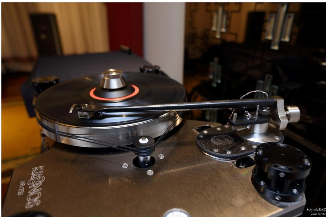
另外特別的是唱臂 Helena，但這非由他自己設計，而是向一位專門製作唱臂的人所訂製的，他說這唱臂很貴但是很棒，他採用這隻唱臂並非為了賺錢，單純是聲音考量。這隻唱臂以碳纖維手工製成，非常堅固，能夠承受到 250 公斤重量，在唱臂底部有一個很重要的金屬球，所有唱臂上的震動，例如唱針與唱片接觸時產生的震動或是喇叭聲音產生的反饋震動都會傳導到這個金屬球上。它的位置是在整隻唱臂的重心，這非常重要，當震動傳導到不是重心的位置，會產生一個反作用力，使得整隻唱臂晃動，Kronos 唱盤搭配這隻唱臂時，在播放音樂的狀況下，輕輕搖動唱盤也不會影響到聲音，因為搖動唱盤時產生在唱臂上的外力會引導至這個金屬重心球上，而唱臂的平衡又非常精準，所以不會使得唱臂與唱針左右晃動，聲音也就不會受到干擾，他說就算是 Kronos 的唱盤搭配其他唱臂也不會有這種效果。
