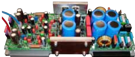
這是 720 的電源線路板。
