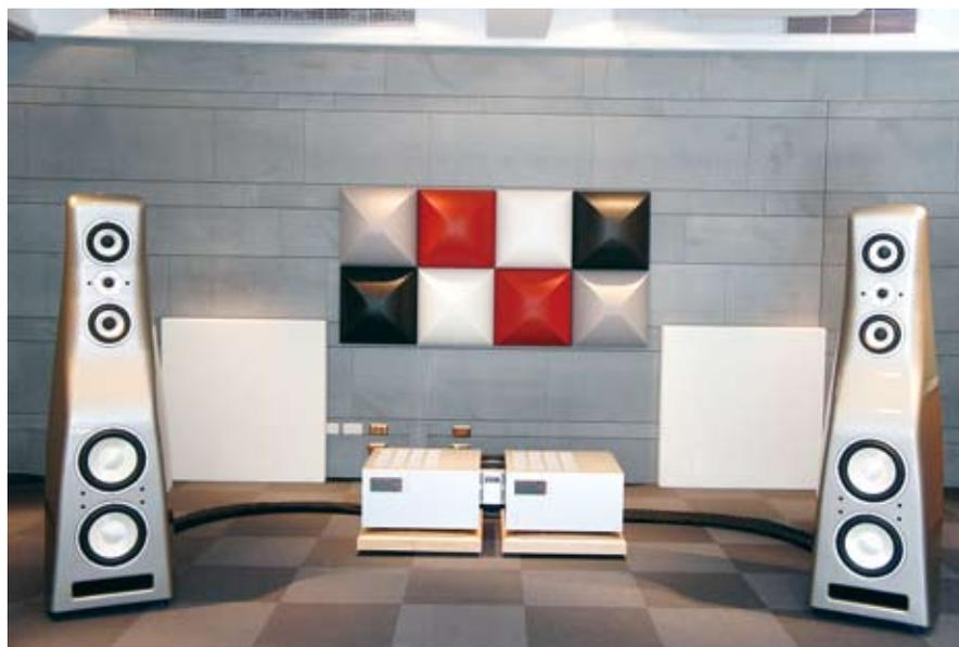
↑ 700是Soulution最頂級的單聲道後級，原廠說明書中，載明700其實就是利用710立體後級的線路橋接而成。710內部使用二個1,000VA環形變壓器，250,000mfd濾波電容量，8歐姆負載下每聲道輸出120瓦，4歐姆負載每聲道輸出240瓦。而700在8歐姆負載下每聲道輸出400瓦（橋接之後的理論最大輸出值是原來的四倍），4歐姆負載下每聲道輸出800瓦。
