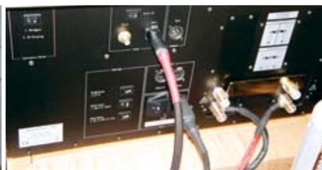
↑700的背板上有XLR與RCA輸入端各一組，另外還有一個XLR輸出端子。由於可以做單聲道或雙擴大機使用，因此提供二種喇叭線接法。背板上有許多開關，包括橋接或雙擴大機用法切換開關、面板設定開關，以及不同的喇叭線接法。
