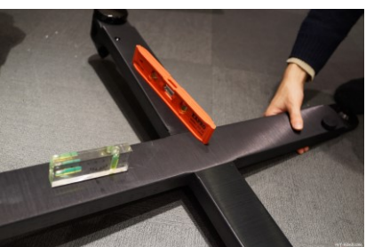
安裝時最好準備水平儀，可進行水平校準
