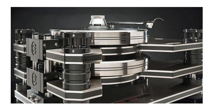
頂級黑膠系統的市場越來越熱鬧,來自加拿大的 Kronos 以反方向雙轉盤(Dual platter counter-rotating revolution)革命性的設計,解決了黑膠唱盤最為關鍵的晃動問題。有什麼是最有效可以完全抵消正向作用力的?那就是完全相等的反相作用力,Kronos 便是運用此種設計,一個黑膠唱盤上同時有兩個完全一樣,但是反相運作的轉盤,達到動態穩定。雖然如此一來製作成本會大幅增加,但聲音的表現也達到前有未有的境界。
