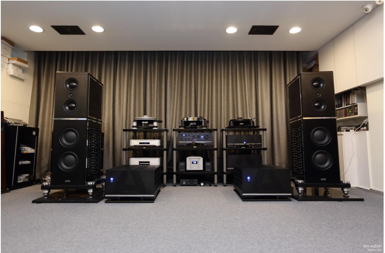
這套系統使用兩個型號共三個電源處理器，中央的是IsoTek EVO3 Mosaic Genesis，提供3組中用量電源輸出(供電量150瓦)，採用IsoTek新的sine wave generation技術，能提供極為純淨的電力，降低噪訊達85dB，並且是下探到0Hz。提供2組高電流輸出(供電量3,680瓦)，有超低阻抗並降低75dB的RFI噪訊。
