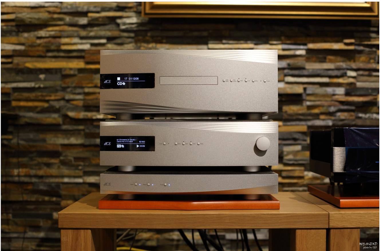
在三台器材當中，中央的便是Rossini DAC數位類比轉換器，同時也具有網路串流與數位前級的功能。這部器材能夠整合所有數位音樂來源，無論是區域網路中的Nas、電腦或是對外網路連接的Tidal、Spotify、Qobuz都能夠直接連接使用，也能使用AirPlay無線連接iOS行動裝置。同樣地透過dCS App執行所有的操作。在我當天抵達時，dCS的全新操作App Mosaic才剛上線不久，翻新並使得操作流程更為直觀，速度也更快了。
