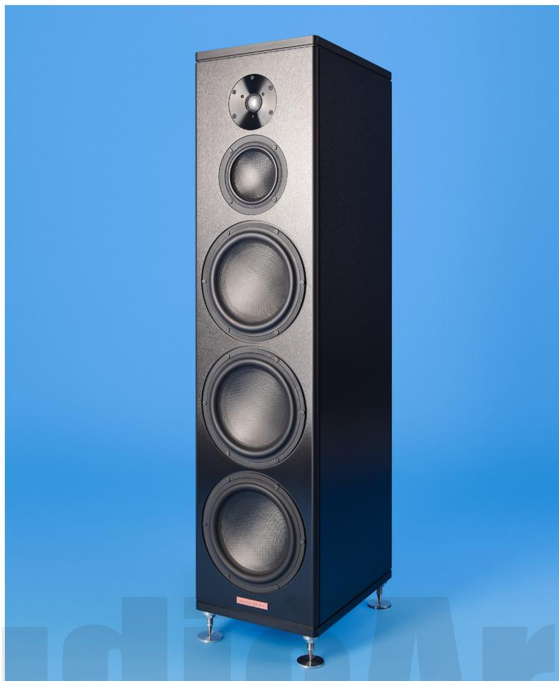
A5的箱體採用鋁合金製成，簡單的矩形，沒有弧形，沒有碳纖維。正面裝了五個單體，包括28mm鈹高音單體、5吋石墨烯奈米單體，9吋石墨烯奈米單體。
