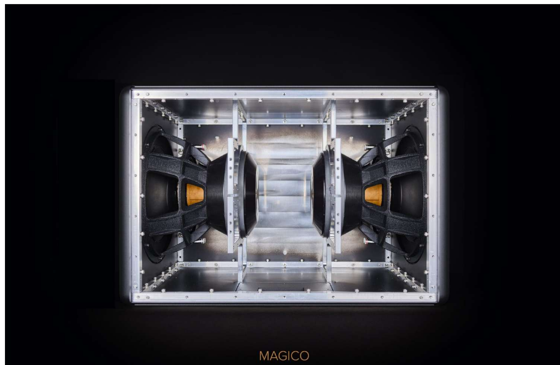
採用兩顆單體對背設計可完全消除多餘的聲壓與能量，代價是成本立刻多出一倍，TITAN 15的單體採用航鈦合金CNC加工製成。
